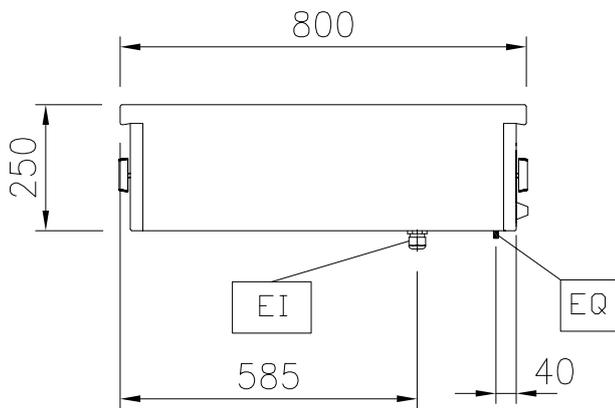
EI = Conexión eléctrica (energía)
